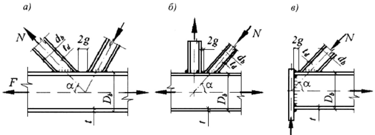
а - К-образный при треугольной решетке; б - то же, при раскосной решетке; в - опорный
