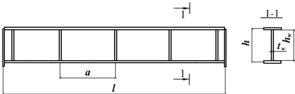
Рисунок М.1 - Схема балки с гибкой стенкой
